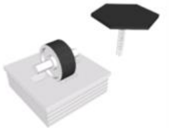
Rolle herausnehmen remove the wheel Retirer la roulette
